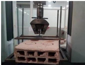
Figure 6 : Dispositif de l'essai d'adhésion
