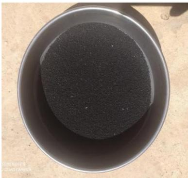
Figure 2 Déchet de pneus broyé [0/2 mm]
