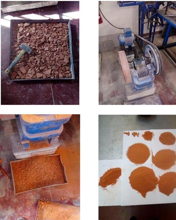
Figure 1. Fabrication du déchet de brique en terre cuite et l'appareil de concassage utilisée.
