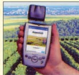
Logiciel de collecte de données géographiques. Compatible avec tous les types de récepteur GPS et fonctionnant sous environnement Windows CE, il permet l'enregistrement d'objets Point, Ligne et Surface et les attributs associés, entièrement paramétrable par l'opérateur.
