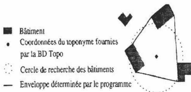
Figure 12 : Construction d'une enveloppe de bâtiment
