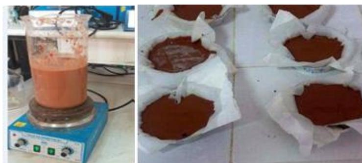
Fig.3. Activation de l'argile par acide.
