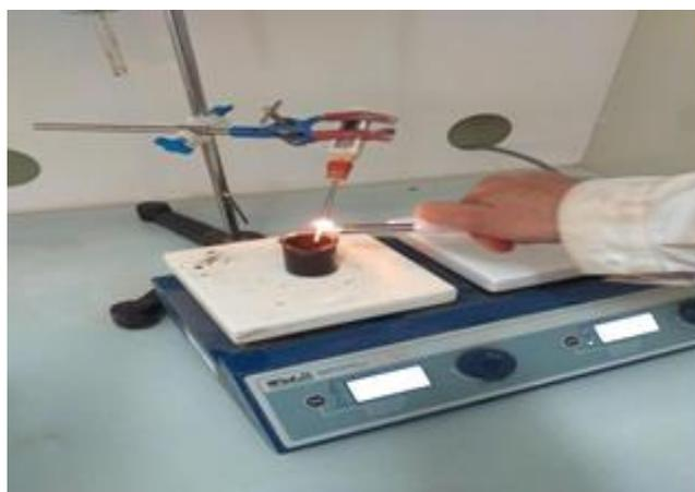
Fig. 11. Mesure de point d'éclair.
