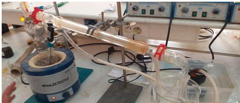
**Fig. 6.** Distillation des huiles usagées.
