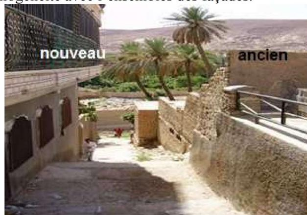
Figure 11/12 : ksar : habitations à modèle importé, des façades transformées et des nouveaux matériaux utilisés
