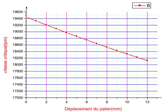
Figure 11- Variation de la vitesse critique en fonction du déplacement du palier
