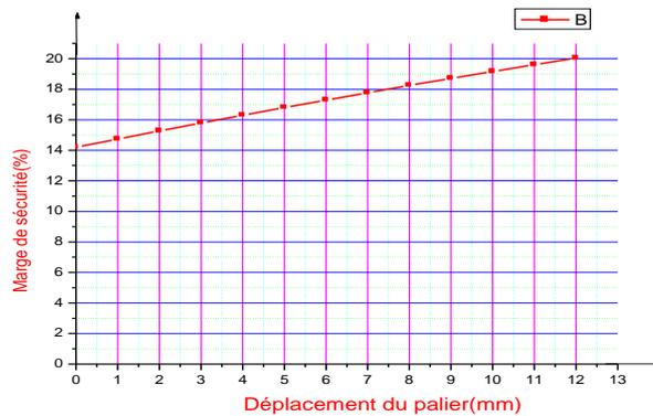
Figure 12- Variation de la marge de séparation en fonction du déplacement du palier
