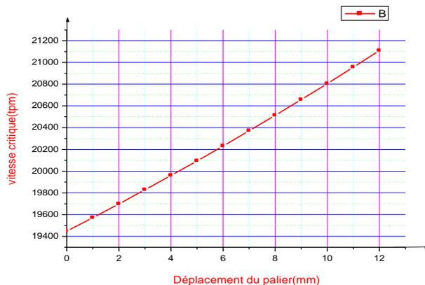
**Figure 6- Variation de la vitesse critique en fonction du déplacement du palier**
