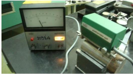
Figure 4. Rugosimètre PERTHEN
