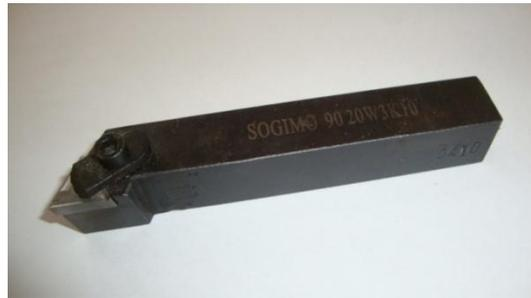
Figure 2 .Plaquette et porte plaquette
