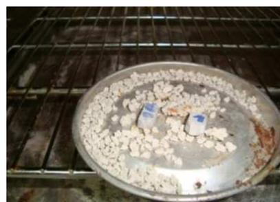
Fig. 3. Prétraitement des échantillons en présence de gel de silice à 45° C.
