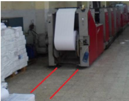
Stocker deux bobines en face de leur emplacement, afin que l'agent puisse les pousser pour les poser sur la machine sans manipulation supplémentaire. Il peut être utile de tracer un repère visuel sur le sol désignant le chemin de la bobine jusqu'à son emplacement.
