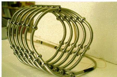
**Figure (6): Prototype de mélangeur chaotique de type Dean alterné**
