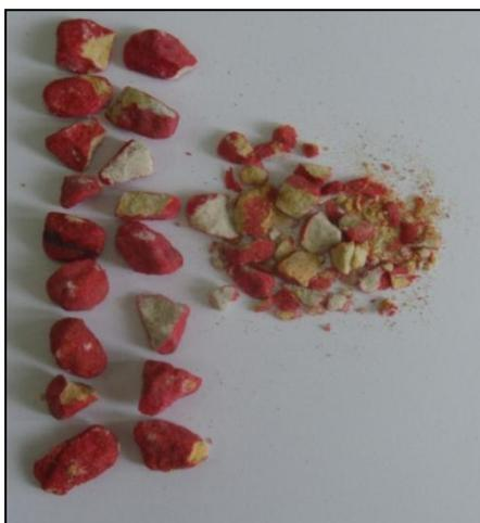
Figure 5 : Grès (5/8) après cisaillement sous 300 kPa.
