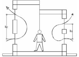
Figure (12). Effet de la hauteur de plafond sur le mouvement d'air intérieur.
