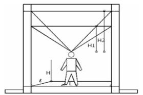
**Figure (10)**. Effet de la hauteur de plafond sur la radiation du toit reçu par l'occupant.
