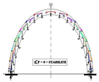
Fig. (19). Arc parabolique, forme auto stable. Source: L 'auteur: (2007).
