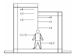
**Figure (11).** Effet de la hauteur de plafond sur la graduation de la température de l'air intérieur ; une différence de 1/2.C° perçu par l'homme.
