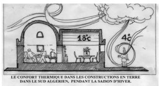
Figure (9). Confort thermique en hiver.
