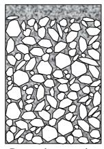
Distribution régulière des gros granulats dans la masse du béton
