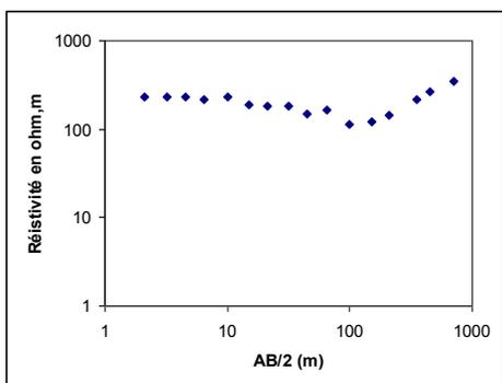
Figure 2: Détermination de la profondeur (P) de l'aquifère dans le cas d'une courbe H (2<sup>ème</sup>) cas  $P = A/3$ .
