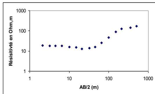
Figure 1: Détermination de la profondeur (P) de l'aquifère dans le cas d'une courbe H (1<sup>er</sup> cas P = A).
