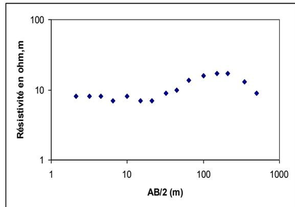
Figure 5: Détermination de la profondeur (P) de l'aquifère dans le cas d'une courbe K
