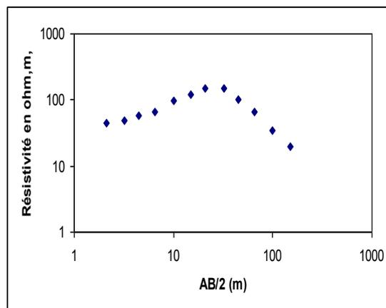
Figure 3: Détermination de la profondeur (P) de l'aquifère dans le cas d'une courbe K 1<sup>er</sup> cas  $P = A$ .
