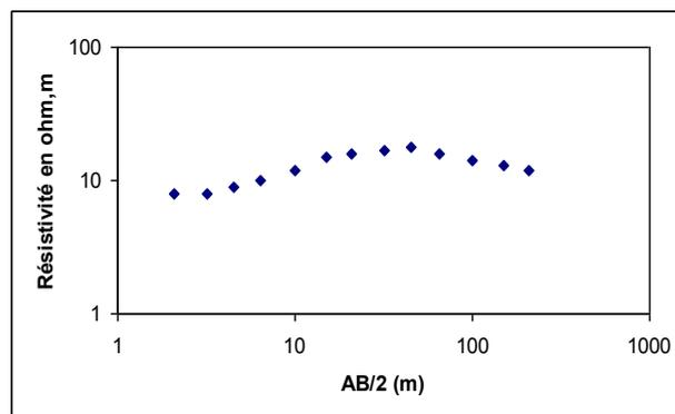
Figure 4: Détermination de la profondeur (P) de l'aquifère dans le cas d'une courbe K 2<sup>ème</sup> cas  $P = A/3$ .
