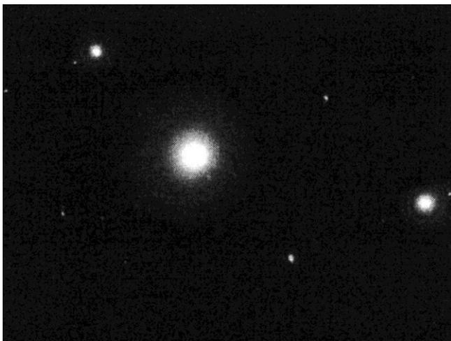
**Figure 6:** Diffraction électronique correspondant à la phase Co cfc.
