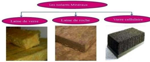
Fig. 2: Quelques types des isolants minéraux
