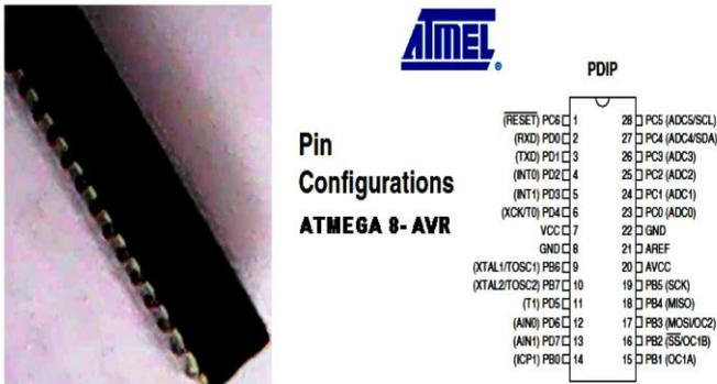
Fig. 3: Microcontrôleur Atmega 8-AVR
