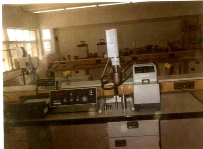
Photographie. 2—Chaîne de mesure pour le Rotovisco RV12
