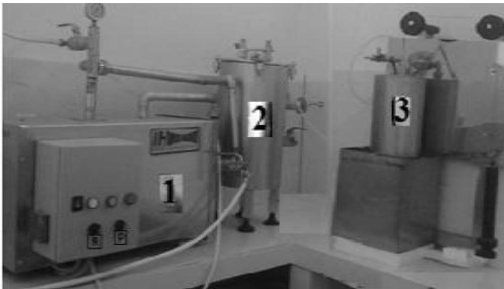
*Fig 1. Aspect général du digesteur : Thermorégulateur (1), Digesteur (2) Gazomètre (3)*
