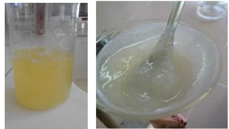
Fig. 2 a-Solution de NaOH après la filtration, b-solution de la kératine obtenue
