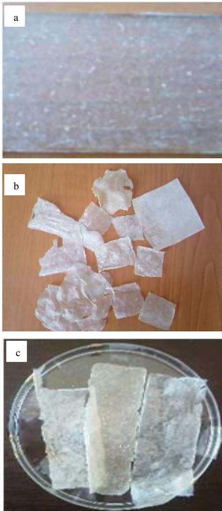
Fig.3 Représentation des films de kératine obtenus par hydrolyse alcaline. (a) films de kératine obtenus sur les lames de verres, (b) films de kératine obtenus dans les boîtes pétri, (c) des films détachés de lames de verre après immersion dans l'eau.
