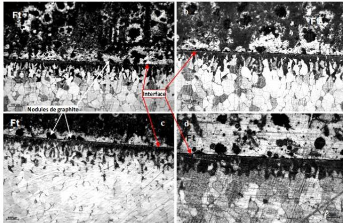
**Figure 4** : Micrographies de la jonction entre la fonte GS et le Fer soudée à : a- 800°C, b-850°C, c-900°C et d- en cyclage 700⇌900°C.
