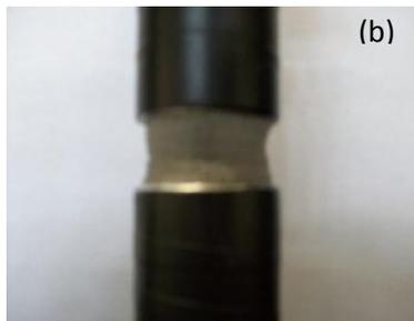
**Fig. 6.** Echantillon sous compression statique. (a) avant chargement (b) après compression de 80 %.
