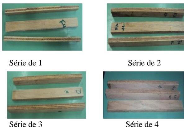
Fig.2-Eprouvettes pour les essais de flexion selon la norme ; AFNOR NF T 54 – 606 (1987)
