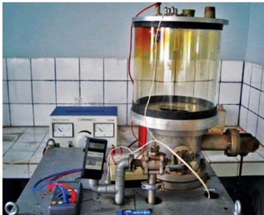
Figure 1. L'appareil d'implantation ionique
