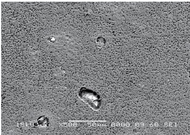
**Figure 10.** microphotographie des alliages à 8%W avec un traitement de surface par implantation ionique de 4 jours, après immersion dans la solution pendant 7 jours.
