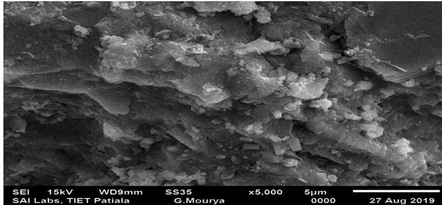
*Fig. 12(d). SEM analysis after 120 days of HPC mixes: (d) R19*
