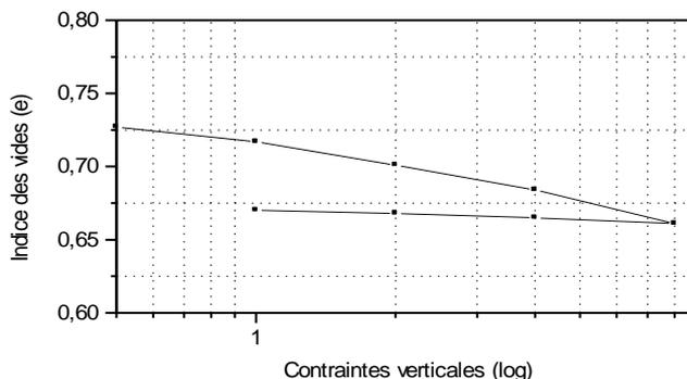
**Fig. 2** Essai oedométrique de la vase d'Oued El-Macta
