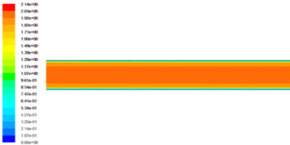
**Fig.4.d.** Distribution de la vitesse horizontale en (m/s) dans la conduite principale (pour T=4.5 s)
