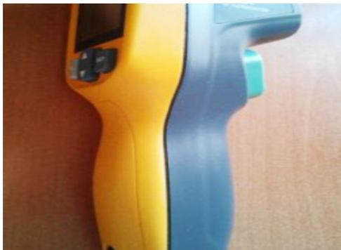
Fig. 05 thermomètre infrarouge utilisé.
