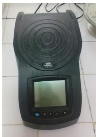
Figure 8: Photomètre UV 440 µm
